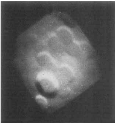
Fig. 7. Wachstumspyramiden an einer Rhombendodekaederfläche. Vergrößerung 460fach
