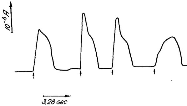
Abb. 6. Stromzeitkurven bei konstantem Potential ( $\eta = 6$  mV) nach einem Überspannungsimpuls ( $\eta = 13$  mV,  $\tau = 1$  ms), bei welchem ein zweidimensionaler Keim entstanden ist. Der Zeitpunkt der Impulsanlegung ist mit Pfeil markiert.
